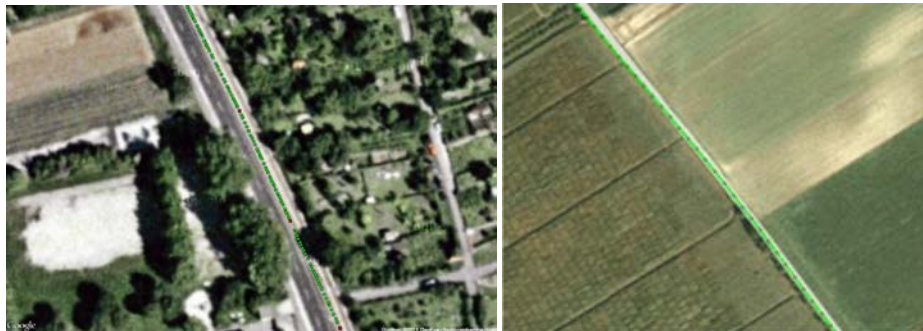
Abbildung 3 Interpolierte GPS-Messungen (rot: gemessene GPS Position, grün: interpolierte Position)
